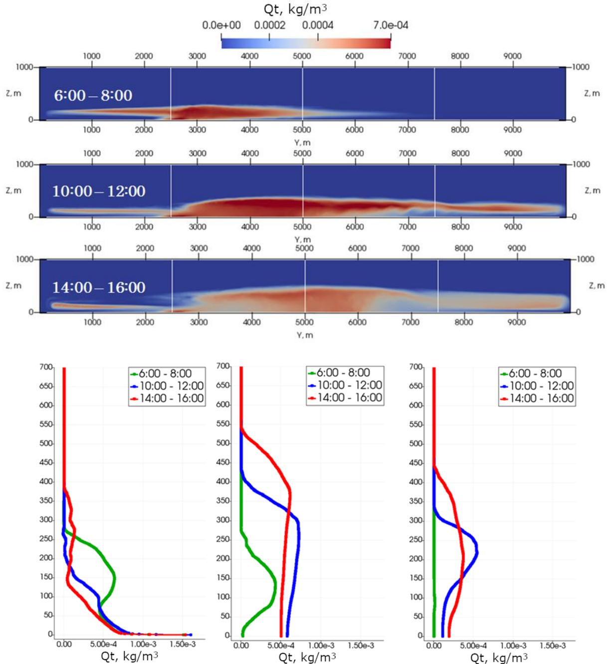
Рисунок 4.18 - Осредненное по различным интервалам времени распределение удельного паросодержания в сечении  $X = 2500$  м (сверху) и профили удельного паросодержания в трех различных сечениях  $X = 2500$  м,  $Y = 2500$ ,  $5000$ ,  $7500$  м (снизу)
